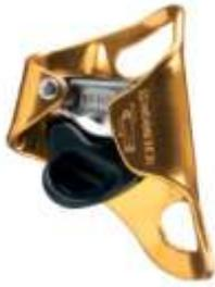
Il **croll** e la **maniglia** sono standard (Figure). Il croll viene attaccato direttamente nel delta che chiude l'imbrago e collegato al pettorale tramite il tiracroll. La maniglia viene collegata al delta con la longe e possiede un pedale, cioè una staffa, in cui si può infilare un piede od entrambi per innalzarsi durante la risalita su corda. La longe della maniglia è la più lunga.
